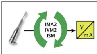
Signalaufbereitung von LVDT-Sensoren Signal conditioning of LVDT d isplacement sensors
