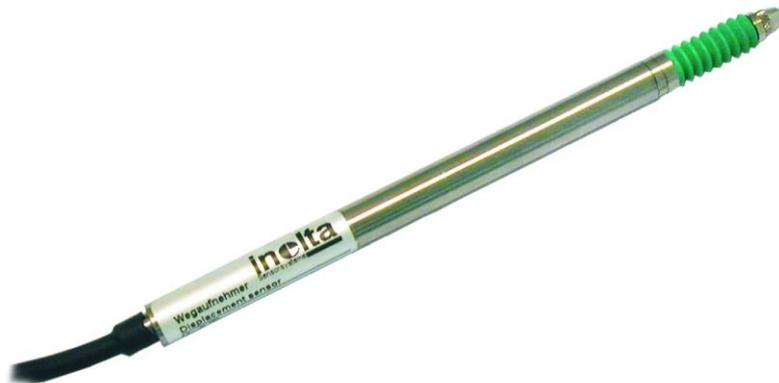
**Bild:** Die LVDT-Wegsensoren der Serie ILAT haben einer Gehäuselänge von 79 mm und einem Durchmesser von nur 8 mm
