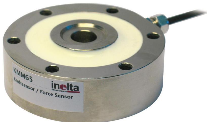
**Bild:** Die Kraftsensoren aus der Baureihe KMM65 von Inelta sind zur Messung von Zug- und Druckkräften zwischen 1kN und 500 kN erhältlich
