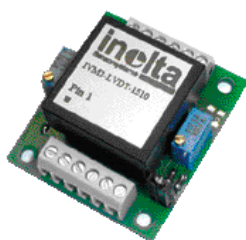
Adapterplatine mit Klemmen und Trimpotentiometern Adapter board with terminal and trim-potentiometer
